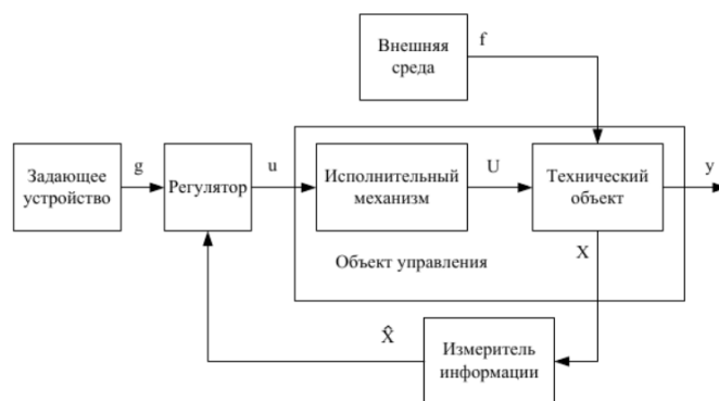
Рисунок 1.1 – Обобщенная функциональная схема системы управления
